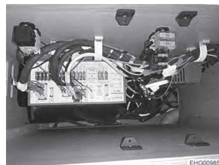
Afb. 75 Inbouwplaats elektroblok (Ford)
